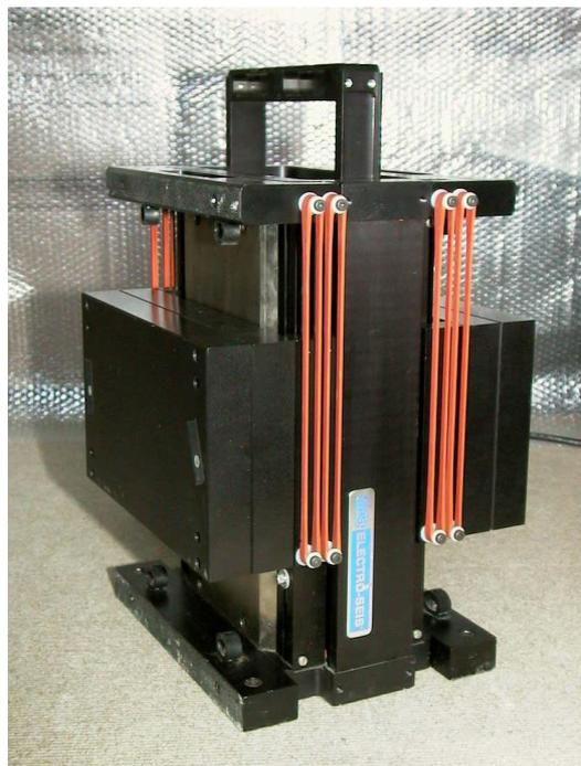
Abb. 6: Dynamischer Erreger von APS mit 30 kg schwingender Masse
