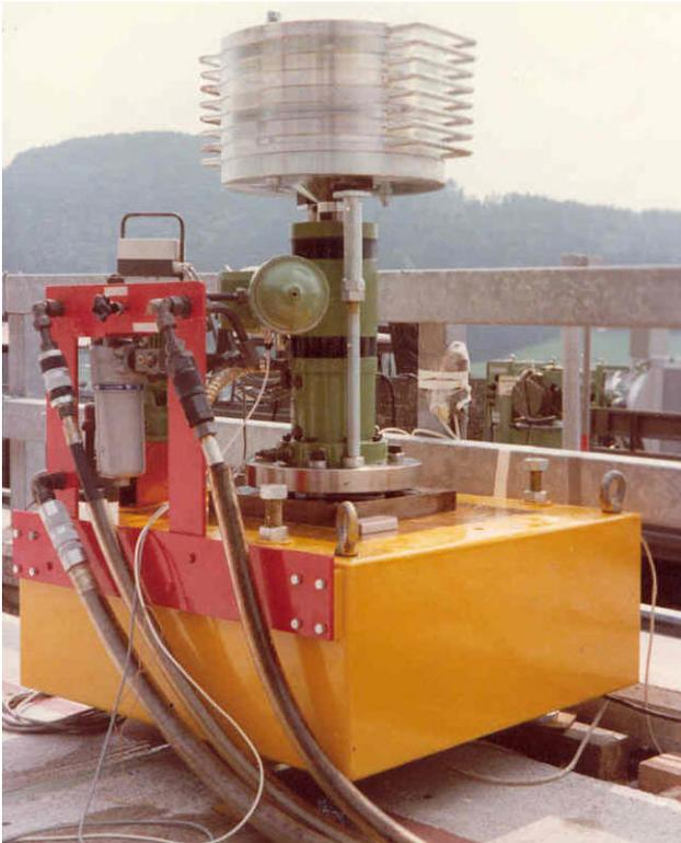
Abb. 5: Servohydraulischer Schwingungserreger.
