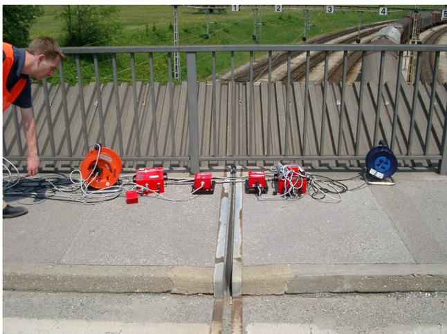
Abb. 9: Messpunkte Fuge (Gerbergelenk)
