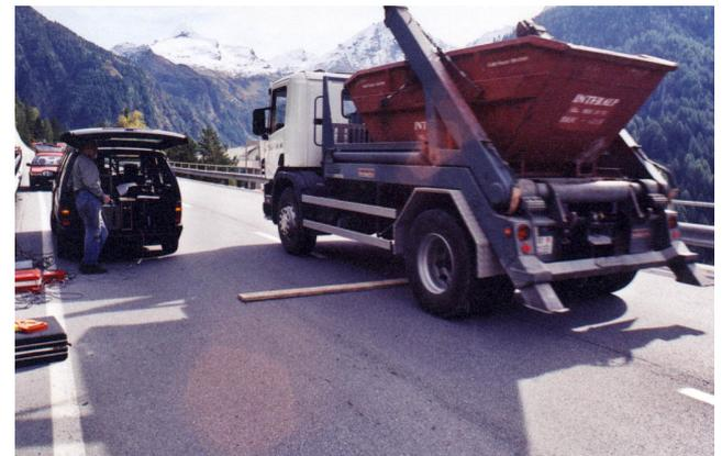
Abb. 11: 16-t-Lastwagen beim Befahren eines Brettes
