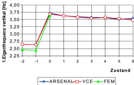
Abb. 14: Zeitverlauf der ersten Eigenfrequenz
