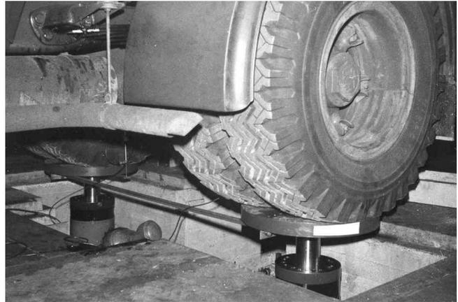
Abb. 10: Harmonische Anregung der Hinterachse.
