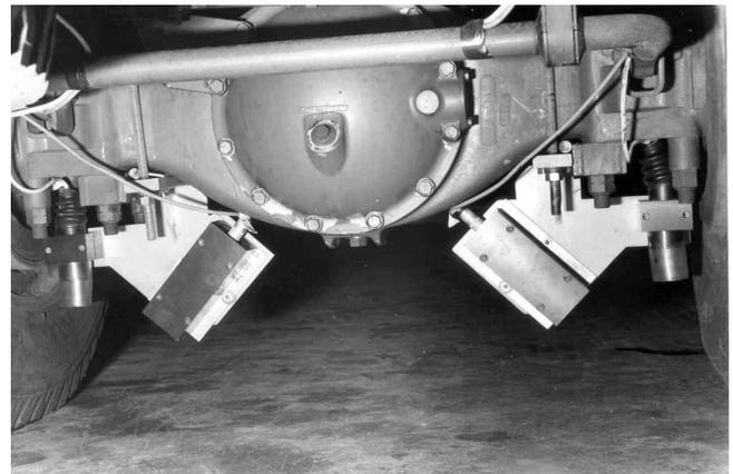
Abb. 13: Optoelektronische Systeme für die Messung dynamischer Radlasten, hier an den beiden Hinterrädern eines Zweiachsers. Sender vertikal.
