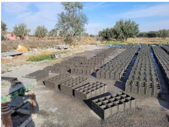
Figure 4-3 : Fabrique artisanale de briques en béton près d'Amizmiz (crédit E. Lattion).
